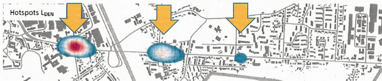
Abbildung 2: Über 24-Stunden (Day, Evening, Night = DEN) gemittelte Hotspots an der Walder Straße (L85), LAP Hilden S. 41
